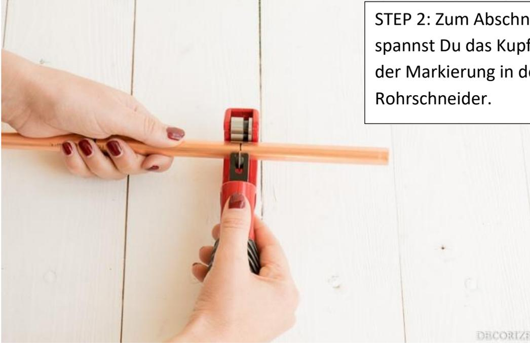
STEP 2: Zum Abschneiden spannst Du das Kupferrohr an der Markierung in den Rohrschneider.
